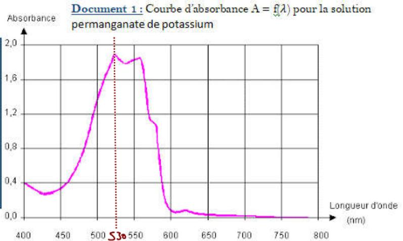
Spectre de la lumière blanche ayant traversé la solution aqueuse de permanganate de potassium
